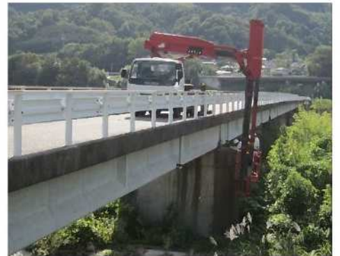
点検車による点検実施状況（入戸野橋）
