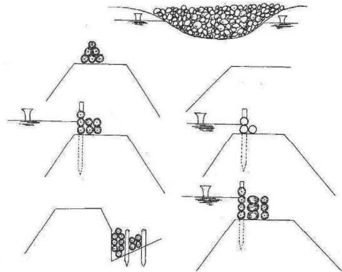
この工法は堤体の沈下の場合或は堤高以上の水位に達するときは尖端表肩より50cm乃至1mを隔て所要の高さまで土俵或は上のうを以て積立てるものとする。
