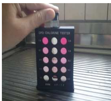
給水栓での毎日検査
