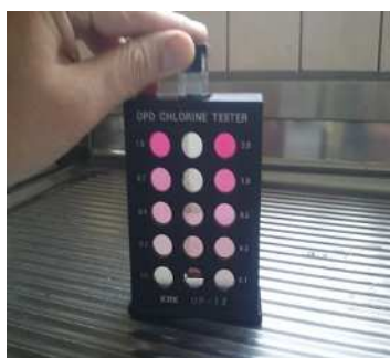
給水栓での毎日検査
