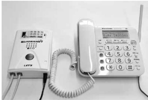
この装置は、着信前に「この電話は振込詐欺等の犯罪被害防止のため、会話内容が自動録音されます。」とアナウンスを流し、振込詐欺を抑止する機能を有しています。
