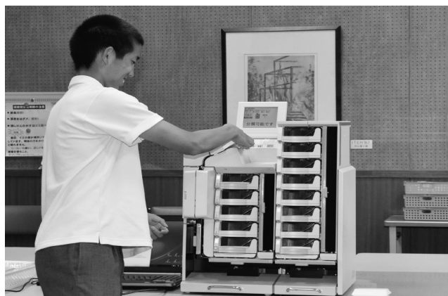
▲自動読取分類機を使用して、票の仕分け
